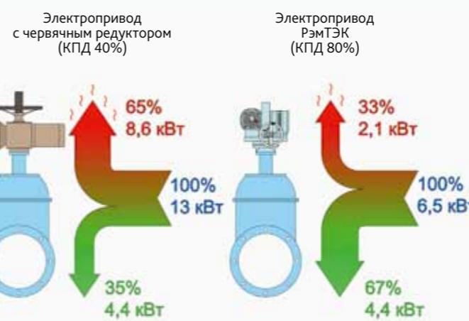
Рис.2. Распределение потоков мощности
