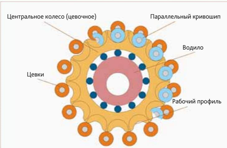
Рис.3. Схема цевочного редуктора
